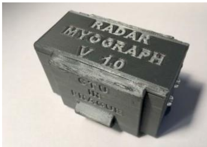
Obrázek 1: Radar Myo Graf - bezkontaktní elektromyograf s využitím radarové techniky pro měření svalové aktivity pacientů
