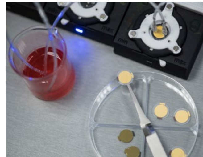
Funkční biočipy jsou vloženy do tzv. průtokové cely a pomocí mikrofluidického systému je analyzovaný vzorek dopraven na povrch.
