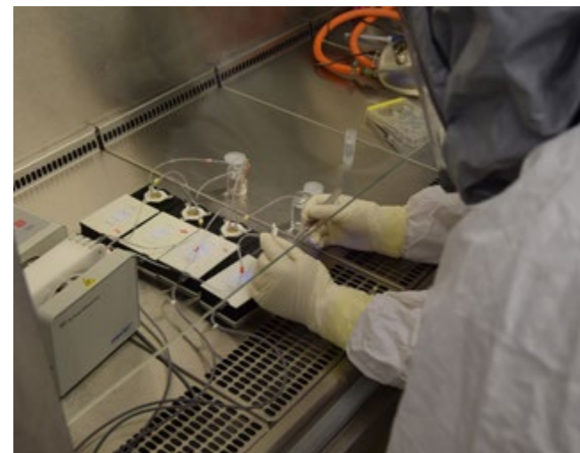
Funkční biočipy jsou vloženy do tzv. průtokové cely a pomocí mikrofluidického systému je analyzovaný vzorek dopraven na povrch.
