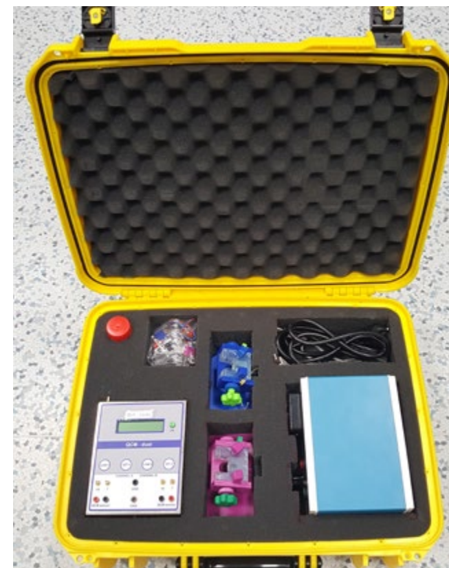
První prototyp sestavy piezoelektrického senzoru pro policii.
