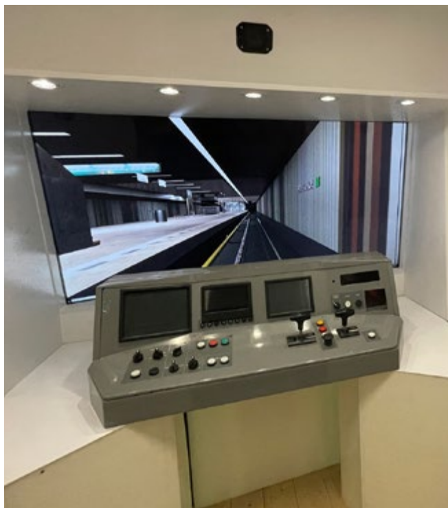
K vývoji zařízení slouží univerzální simulátor kolejového vozidla.
