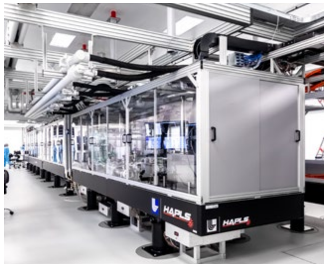
Použitý laserový systém využívá k čerpání nejjasnější diody na světě.
